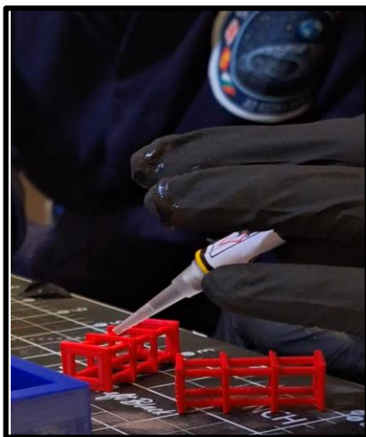
Sklejanie zbrojenia z filamentu
