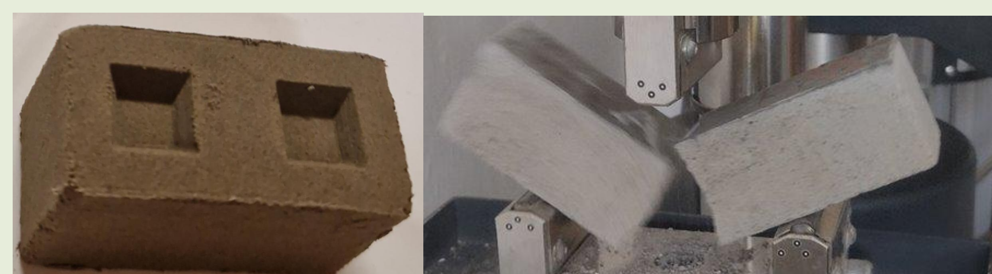
Element konstrukcyjny wykonany z analogu regolitu i badanie materiału przy zginaniu.
