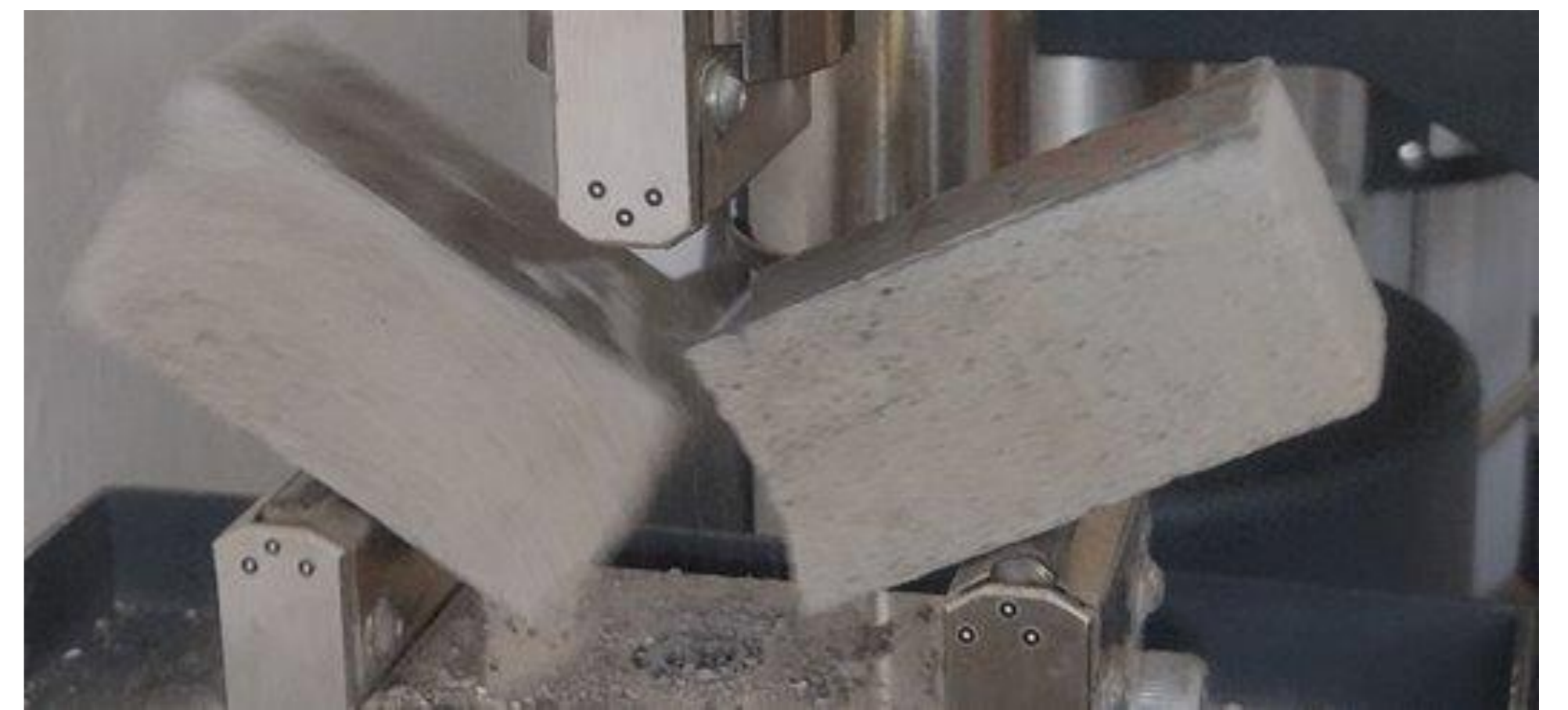
Rys.1. Próby wytrzymałościowe geopolimeru
