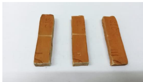
Ryc. 2. Kształtki przygotowane z masy plastycznej z dodatkiem SiC przeznaczone do badania wytrzymałości na zginanie
